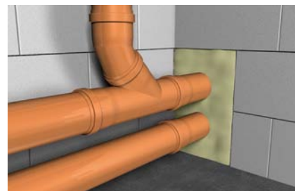
Vyplňování vstupů potrubních systémů
