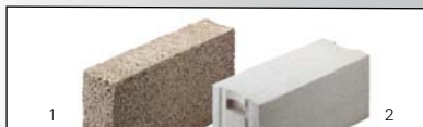
1. Plná cihla z lehčeného betonu, plná cihla z bentonitu, např. "Liapor", "Gisoton" 2. Pórobeton, např. "Ytong", "Hebel"
