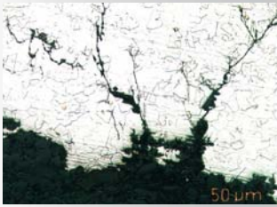
Příklad trhliny způsobené transkrystalickou korozi napětím v plechu 1.4401, který byl vystaven značně velkým účinkům chlórů..
