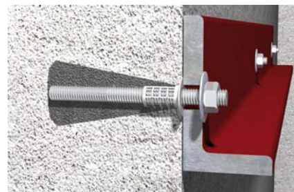
Detail: Otvor v pórobetonu
