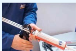
Před aplikací temperujeme Anticor Seal 511 na cca 30 °C.
