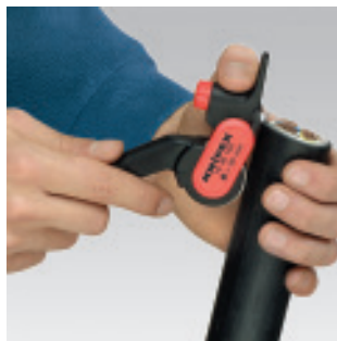
Nasazení nářadí pro odstrižení v podélném směru
