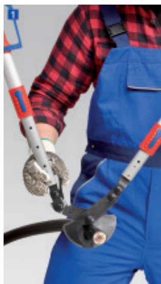
nastavení výhodného rozvětvení ramen
