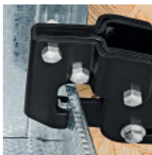
Nasazení kleští na dva spojované profilované plechy
