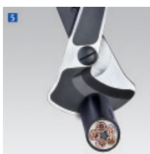
Opakujte řez a rozevíření, až je kabel přeštrpnutý.
