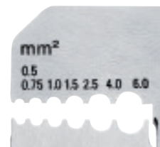
12 21 180: Průřezy drátů v mm 2
