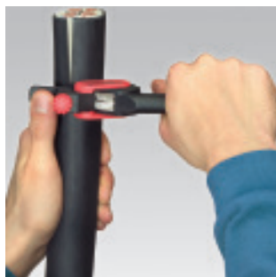
Otáčení nástroje pro obvodový řez
