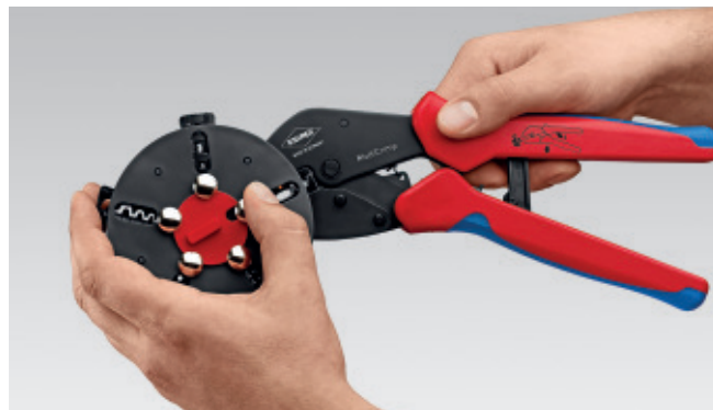
Výměna krimpovacího nástavce: Odaretejte polohu zásobníku, sejměte krimpovací nástavec z kleště.
