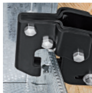
Lisovací nástroj je stlačován profilovanými plechy
