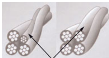
Nosný neutrálny vodič vzdušného vedenia
